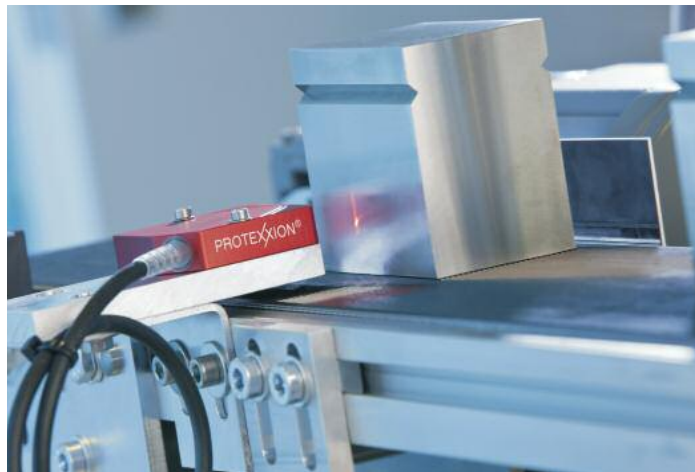
System Protexion: Der Lasersensor zur Authentifizierung lässt sich problemlos in den Produktionsprozess integrieren
