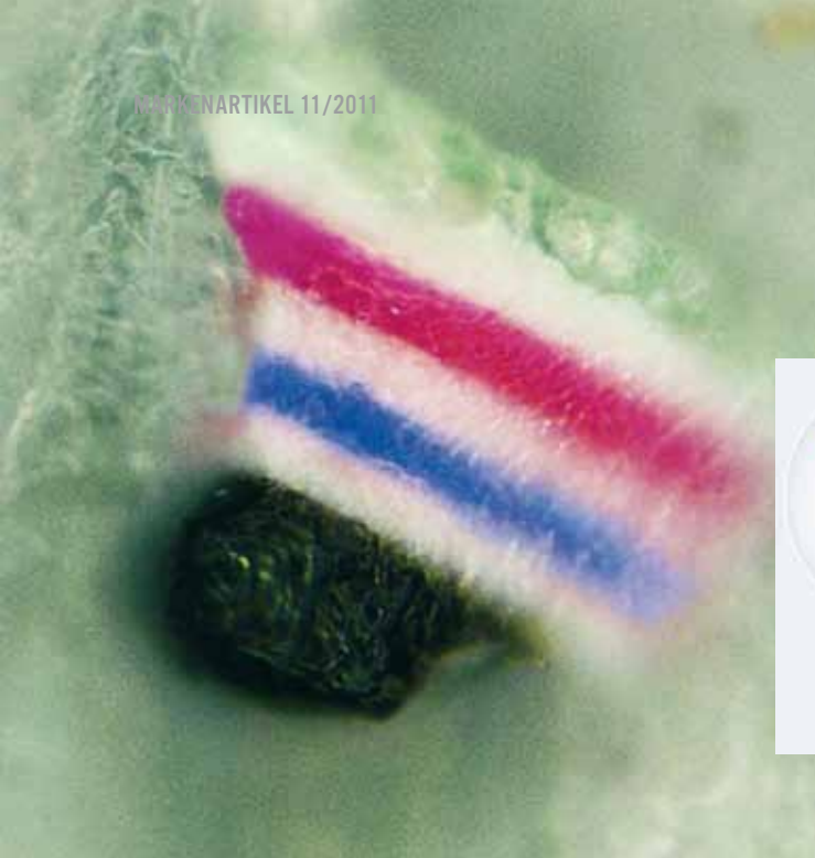
Der Secutag-Code kann mit einem handelsüblichen Mikroskop mit 100-facher Vergrößerung ausgelesen werden (l.).
